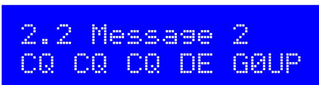
Bei weitem der einfachste Weg, um TEXT-Parameter zu bearbeiten, ist, einfach den CW-Decoder zu verwenden! Wie bereits erwähnt: Der CW-Decoder erwartet eine gut getimte CW mit korrektem Abstand zwischen Wörtern und Zeichen und dass Sie die Zeichen in etwa mit der
