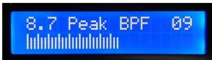
Das Verstellen des C1-Trimmers sollte die Anzahl der Amplitudenbalken ändern. Sie müssen den Trimmer C1 auf MAXIMUM der Amplitude einstellen. Wenn dies gelingt, ist der Peak des Bandpassfilters auf den CW-Abschnitt des Bandes zentriert.
