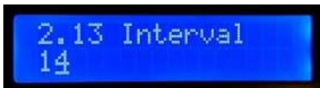
Der unterstrichene Cursor unterhalb der 4 zeigt an, dass die Bearbeitung aktiv ist. Durch Drehen des Drehgebers wird der Parameterwert geändert.
