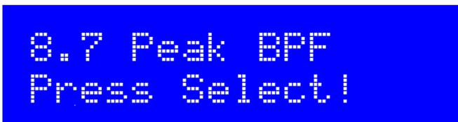
Tun Sie, wie da steht! **Aber wenn Sie Kopfhörer eingesteckt haben, bitte diese zuerst aus den Ohren nehmen.** Der Ton wird sehr laut sein. Drücken Sie die linke Taste ("Select"), um den Signalgenerator einzuschalten, damit Sie den Trimmer C1 einstellen können. Jetzt hören Sie einen lauten Ton bei 700Hz, wenn Sie Kopfhörer angesteckt haben (und diese hoffentlich nur auf dem Tisch liegen). Das Display sieht wie folgt aus:
