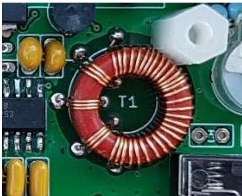
Dieser Transformator hat VIER Wicklungen: Drei identische kurze Wicklungen und eine lange Wicklung. Es gibt also acht Drahtenden, die alle in die richtigen Löcher auf der Leiterplatte gelötet werden müssen und bei denen der Lack richtig entfernt werden muss.
