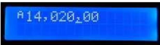
Die verfügbaren VFO-Abstimmraten sind 1kHz, 500Hz, 100Hz oder 10Hz.
