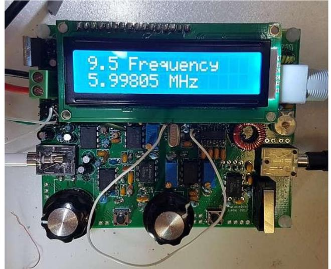
Auf dem Foto verbindet der weiße Draht den FREQ-Pin (knapp unter dem "M" -Zeichen des LCD, im Foto) mit dem Clk0-Ausgangspin (knapp unter dem "z" -Zeichen des LCD). Dies ist eine bequeme Möglichkeit, den Frequenzzähler zu verwenden, um den korrekten Betrieb des Signalgenerators (und damit des Si5351A-Synthesizers) zu überprüfen. Die Signalgeneratorausgabe ist sowohl an den Clk0- als auch an den Clk1-Pins verfügbar, daher können Sie sie beide testen.
