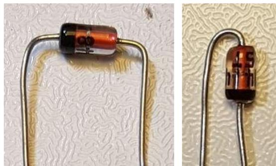
Für D4 muss der schwarze Streifen auf dem Diodenkörper mit dem horizontalen Balken des Diodensymbols auf dem Layout-Diagramm ausgerichtet sein (siehe Foto rechts). D4 ist senkrecht montiert. Die Lage von D4 wird durch das rote Quadrat, in der Nähe links oben im Diagramm auf der folgenden Seite angezeigt.
