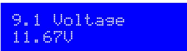
Dies ist die Digitalvoltmeter- (DVM) Funktion. Der messbare Spannungsbereich beträgt 0 bis 20V DC.
