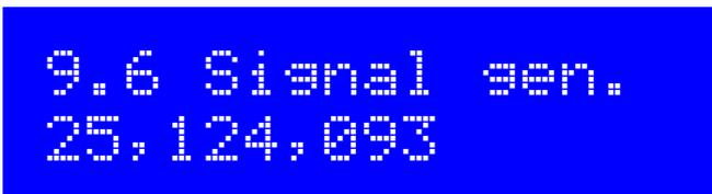
Die Signalgeneratorfunktion ist ausgeschaltet, bis Sie die linke Taste drücken, um sie auszuwählen. Dann erscheint der Cursor unter der 10MHz-Ziffer. Sie können diese Zahl genau wie bei jedem anderen Konfigurationsparameter einstellen. Verwenden Sie den Drehgeber, um die Frequenz zu erhöhen oder zu verringern. Drücken und halten Sie den Drehgeber und drehen Sie ihn, um die Abstimmrate zu ändern (Cursor bewegt sich nach links oder rechts).
