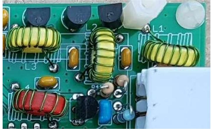
Setzen Sie die Enden der Drähte in die richtigen Löcher der Platine ein und ziehen Sie sie fest, so dass der Ringkern senkrecht auf der Platine sitzt. (Siehe Foto rechts)
